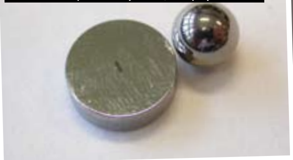
Kmitáním kuličky po destičce mazané naftou vznikne otěrová plocha. Čím je menší, tím lepší je mazivost.
